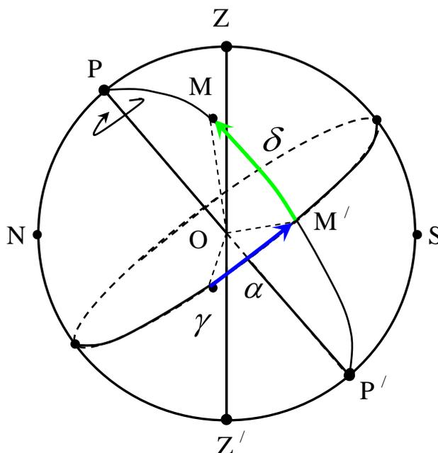
*Склонение* ( $\delta^0$ ) – дуга круга склонения от экватора до светила ( $\angle M'OM$ ). Изменяется в пределах от  $-90^0$  до  $+90^0$ . Измеряется в градусах (минутах и секундах). Иногда вместо склонения светила рассматривают полярное (или полярное) расстояние ( $P^0$ ) – дуга круга склонения от северного полюса до светила ( $\angle POM$ ). Изменяется в пределах от  $0^0$  до  $180^0$ . Измеряется в градусах (минутах и секундах).
