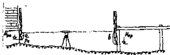
Рис. 40 Вынос на обноску уровня чистого пола
