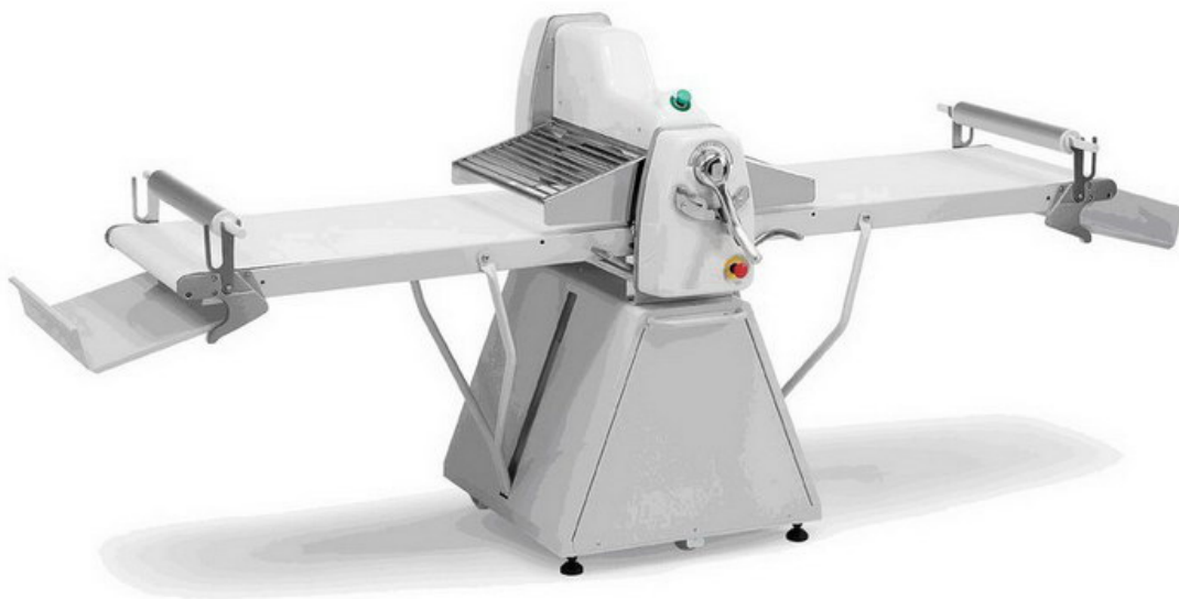
Рисунок 2. Тестораскаточная машина Tekno Stamar (Италия)
