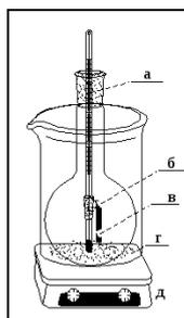
Рис. 19. Схема исполнения опыта: а - термометр для определения первой капли дифениламина(ДФА)- начальной температуры плавления( $t_{\text{нач}}$ ) и конечной температуры ( $t_{\text{кон}}$ )- по плавлению всей массы ДФА в капилляре; б- капилляр с ДФА; в- столбик ДФА; г-водяная баня; д -
