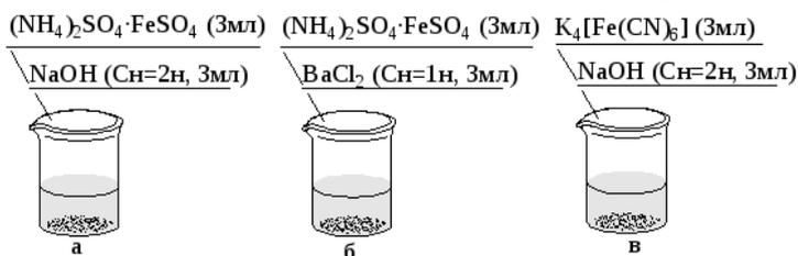
Рис. 21. Схема выполнения опыта: а, б- пробирки с двойной солью; в- пробирка с комплексным соединением.
