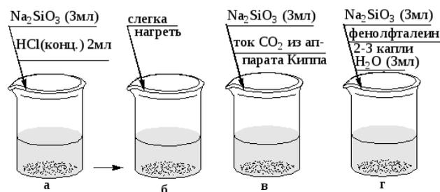
Рис. 17. Порядок проведения опытов: а – г – пробирки с раствором жидкого стекла  $\text{Na}_2\text{SiO}_3$ . Газообразный углекислый газ получают из аппарата Киппа. В пробирке проверяют характер среды введением в раствор жидкого стекла при помощи фенолфталеина.
