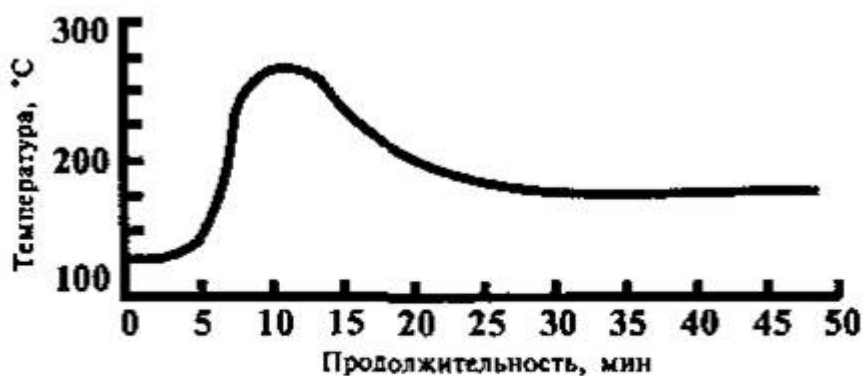
Рис. 71. График температурного режима в пекарной камере
