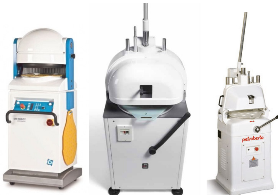
Рисунок 4. Виды делительно-округлительных аппаратов а - автоматические; б – полуавтоматические; в – ручные
