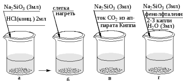
Рис. 17. Порядок проведения опытов: а – г – пробирки с раствором жидкого стекла \text{Na}_2\text{SiO}_3 . Газообразный углекислый газ получают из аппарата Киппа. В пробирке проверяют характер среды введением в раствор жидкого стекла при помощи фенолфталеина.
