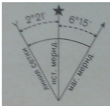
Рис. 11 Схема направлений географического и магнитного меридианов относительно линии сетки
