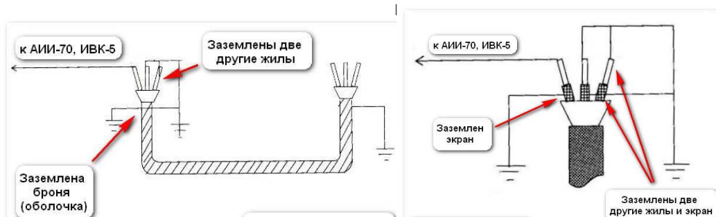
Рис. 11. а - Схема испытания кабеля повышенным напряжением, б- Схема испытания кабеля повышенным напряжением с экраном
