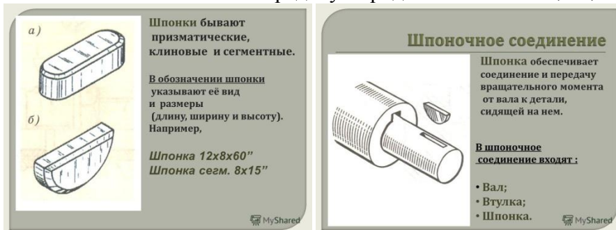
Рис. 16. Шпоночное соединение
