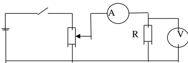
2. Плавно изменяя напряжение в цепи, при помощи реостата измерить значения напряжения и силы тока на R1. Результаты измерений занести в таблицу.
