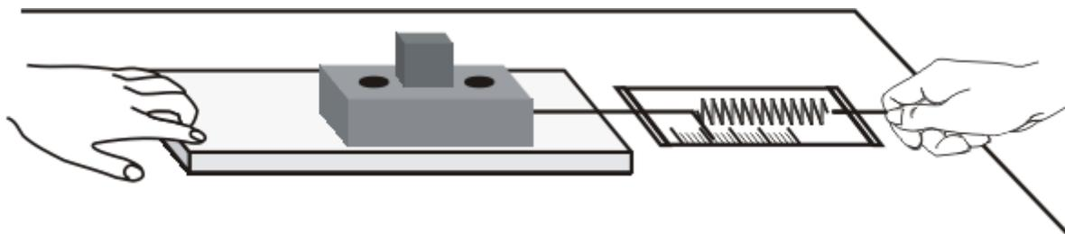
3. Поставив на брусок один груз, тяните брусок равномерно по горизонтальной линейке, измеряя с помощью динамометра прикладываемую силу. Повторите опыт, поставив на брусок два и три груза. Записывайте каждый раз в таблицу, помещенную в тетради для
