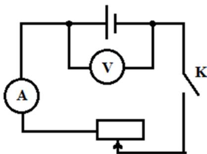
При разомкнутом ключе ЭДС источника тока равна напряжению на внешней цепи. В эксперименте источник замкнут на вольтметр, сопротивление которого должно быть много больше внутреннего сопротивления тока. Обычно сопротивлению источника тока мало, поэтому для измерения напряжения можно использовать школьный вольтметр со шкалой 0-6В и сопротивлением 900 Ом. Так как сопротивление источника мало, то действительно  $R_v \gg r$ .
